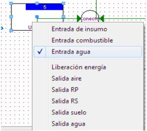
Otra forma de activar los símbolos del proceso se obtiene oprimiendo, en el ratón, el clic derecho, esta acción activa una ventana que muestra el nombre de los símbolos del proceso. Señale con el cursor el
